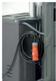
Rangement pour le câble électrique
