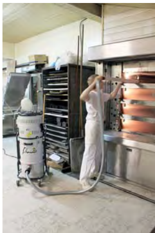
Filtration conique catégorie M 1 \mu Surface filtrante 30 000 cm 2
