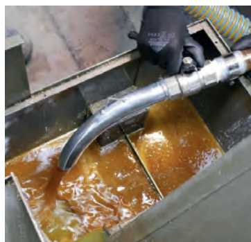
Système de vidange par pompe
