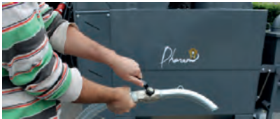
Système de vidange par pompe (300lt/min)
