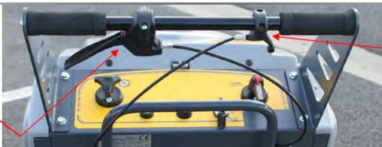
Système FLAP permettant d'absorber les gros déchets.
